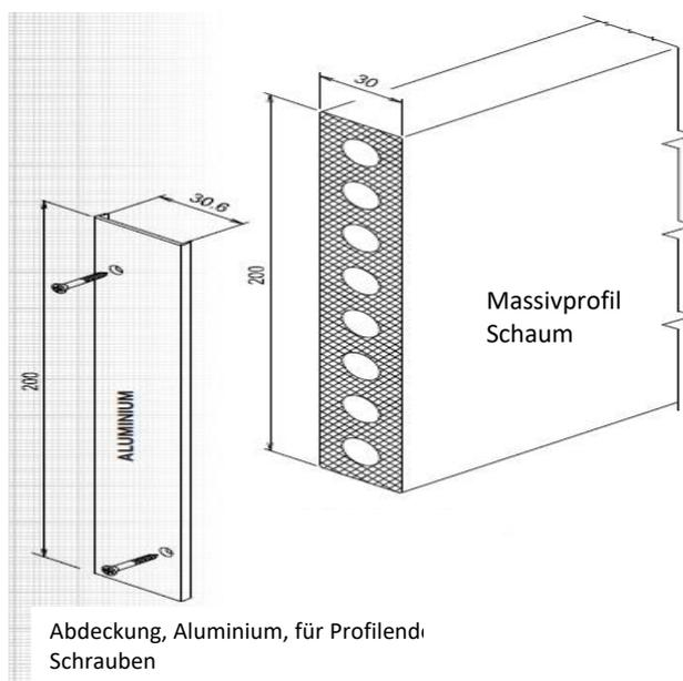
Abdeckung, Aluminium, für Profilend Schrauben (8200)
