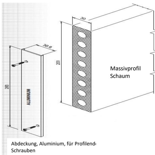
Abdeckung, Aluminium, für Profilend Schrauben (8200)
